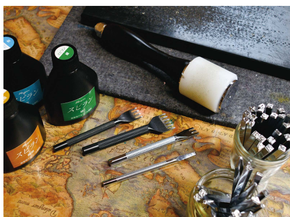
革用の染料、縫い糸を通す穴を開ける道具、刻印用の打ち棒。クラフトはもちろんリメイクやリペアに活躍する。
